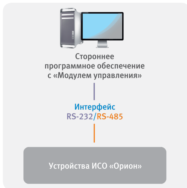
Рисунок 83. Интеграция с устройствами посредством «Модуля управления»
