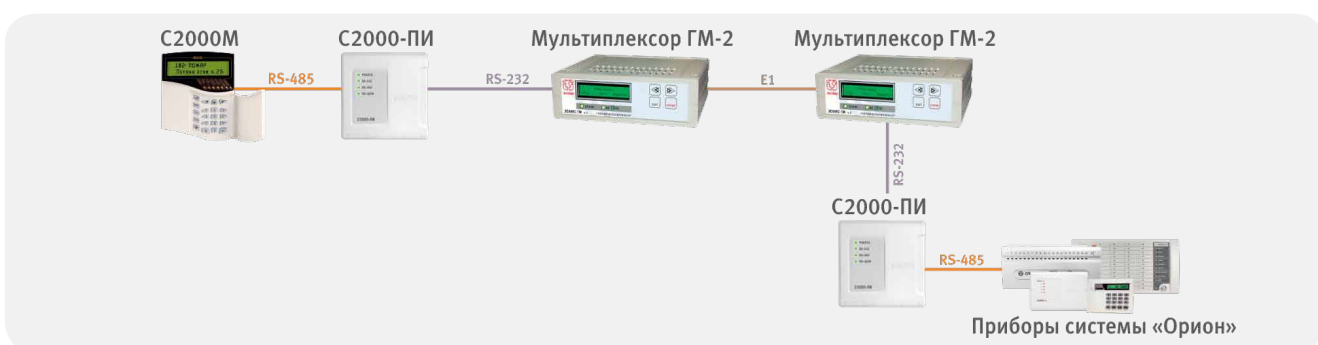
Рисунок 95. Структурная схема использования мультиплексора «ГМ-2» с пультом «С2000М»
