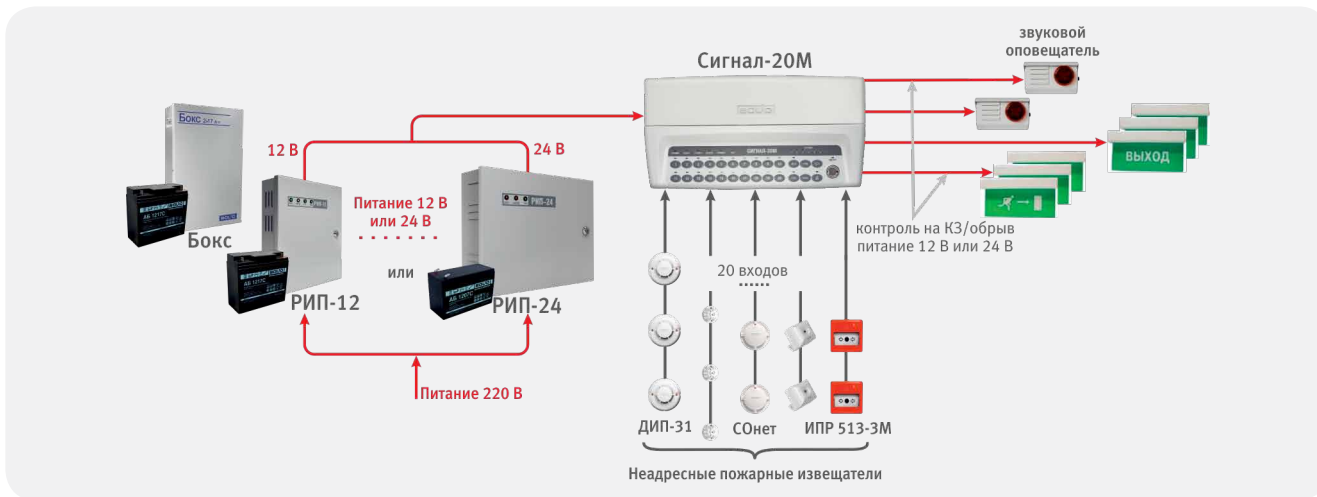
Рисунок 14. СОУЭ 1-го и 2-го типа на базе ППКУП «Сигнал-20М»
