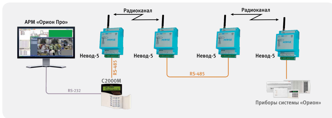
Рисунок 105. Структурная схема использования «Невод-5» с АРМ «Орион Про» и «С2000М», соединение «точка-точка» с ретрансляцией
