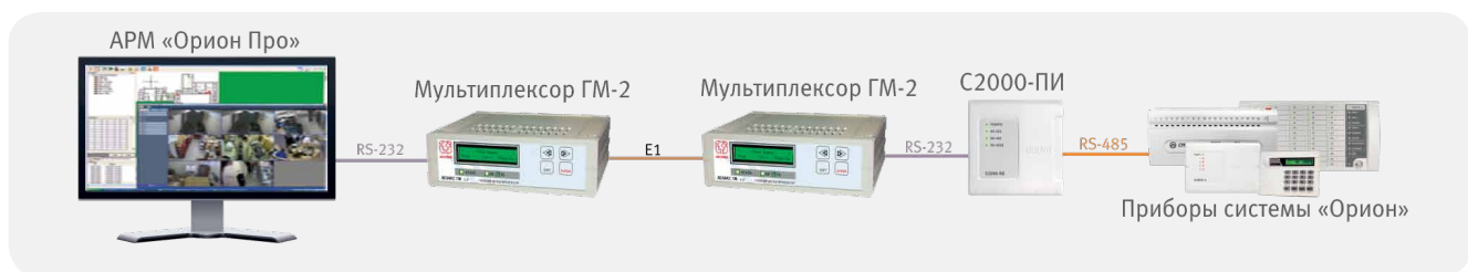
Рисунок 93. Структурная схема использования мультиплексора «ГМ-2» с АРМ «Орион»/«Орион Про»
